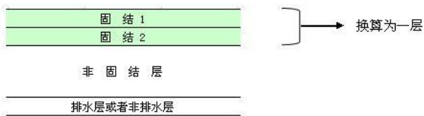
图 2.4.3 计算换算层厚度时不考虑非固结层的情形
