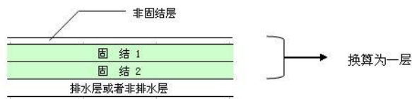
图 2.4.2 计算换算层厚度时考虑非固结层的情形
