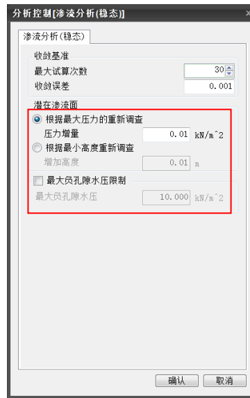
图 3.2.3 潜在渗流面的设置方法
